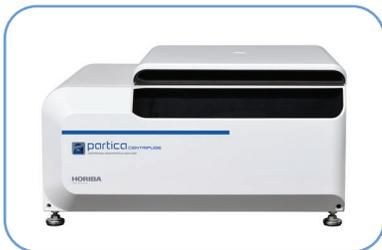
La CENTRIFUGA Partica CN-300 de Partica aplica una fuerza centrífuga de hasta 30 000 gy utiliza control de temperatura para producir resultados de medición precisos para una variedad de muestras. La característica clave de la centrifugación es que el tamaño de las partículas se mide después de clasificarlas por tamaño, lo que da como resultado una amplia gama de mediciones de alta precisión.
