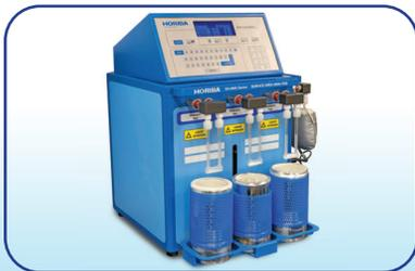
La serie SA-9600 brinda una velocidad y comodidad excepcionales al análisis de área de superficie BET. Las mediciones se basan en BET Dinámico por flujo de gas, que monitorea la adsorción de nitrógeno para determinar el área superficial. El BET por flujo de Gas es un método rápido y confiable para el análisis de área superficial. El SA-9600 permite al usuario determinar rápidamente el área de la superficie con solo presionar un botón.
